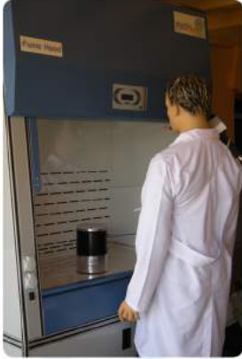
ASHRAE 110 standardında belirtilen çeker ocak performans testine uygunluk
